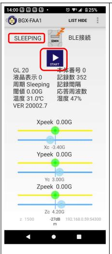
計測をしてない本体に電池を挿 入した直後は G-MEN の液晶は SLEEPING 状態になります この状態で BGX 一覧にて 認識・選択ができた場合(左図)
