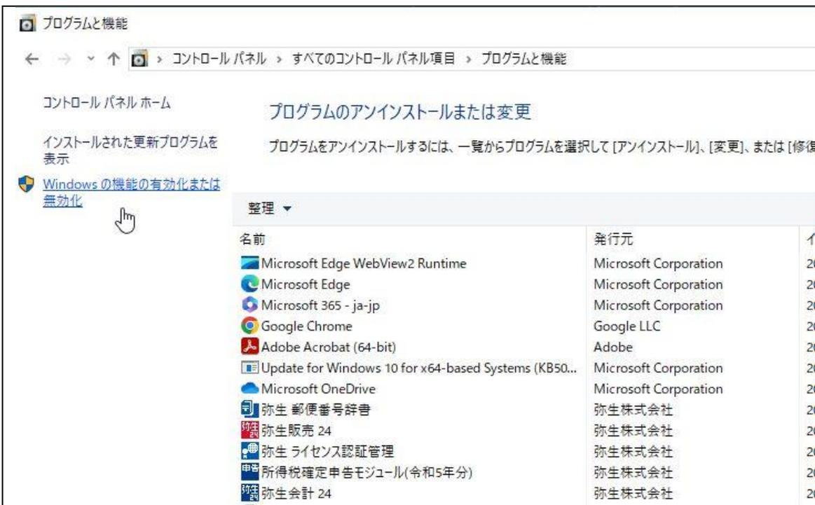
3. Windows の機能の有効化または無効化を開き .NET Framework3.5 のチェックボックス☐をクリックし ■にして有効化にして『OK』をクリック
